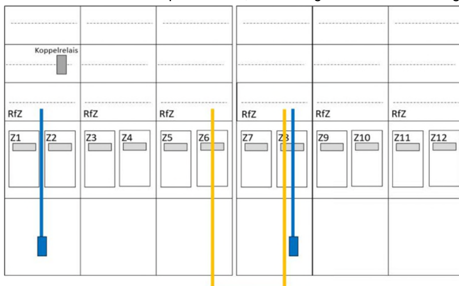
Abbildung 12: Bestandszählerplätze ohne zusätzlichen Zählerplatz bzw. Steuergerätefeld
