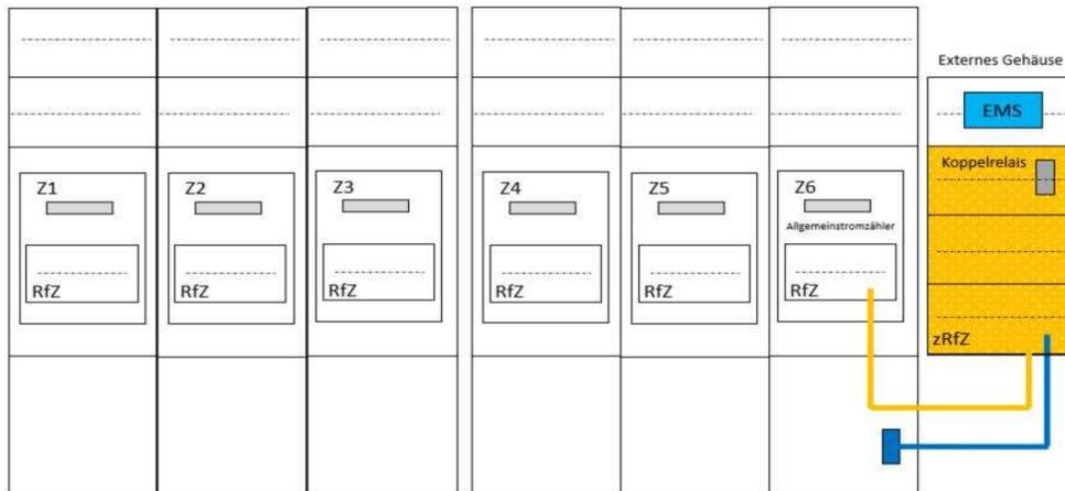
Abbildung 11: Bestandszählerplätze ohne zusätzlichen Zählerplatz bzw. Steuergerätefeld
