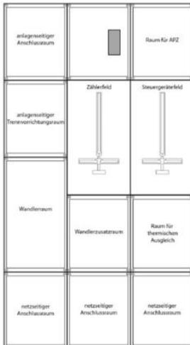
Abbildung 8: Bsp. Wandlermessung 200 A in Neuanlagen
